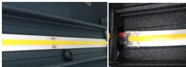
10. Appliquez la bande LED dans l'angle du côté de la sortie des câbles d'alimentation et collez-la au milieu de la rainure de l'auge à LED ou de la bande LED. (fig. 8).
