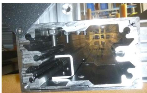
**Attention:** Dans la version LED, le support d'alimentation est vissé à l'intérieur du poteau (fig. 12). Pour le SB400PRO, le support d'alimentation n'est pas utilisé, mais est placé dans le compartiment supérieur de la barre sous la révision.
