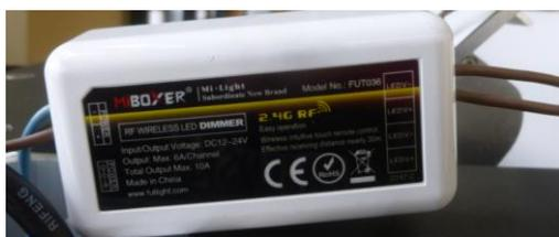
15. Connectez les câbles de sortie de la bande LED au poteau du contrôleur (Fig.12). Faites attention à laisser un câble de rechange afin que le contrôleur soit finalement placé sur l'alimenteur et la connexion correcte selon les marquages sur le contrôleur.
