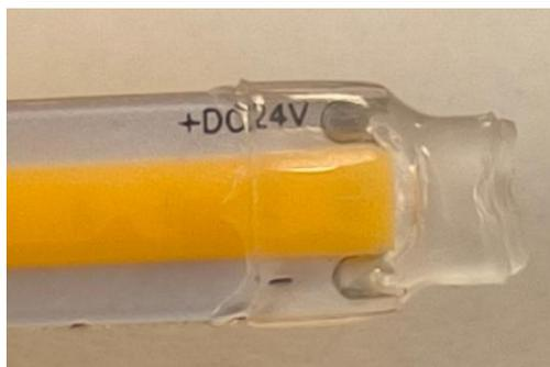
11. Après avoir coupé le ruban à la longueur souhaitée (voir point 9), fixez l'extrémité coupée pour maintenir la protection IP65. Appliquez du silicone sur l'extrémité coupée et placez le bouchon transparent sur le ruban (figure 8A).
