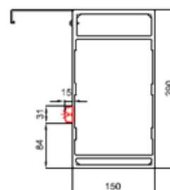
Fig.2 Kit d'éclairage dans la pergola SB500 - emplacement marqué en rouge.
